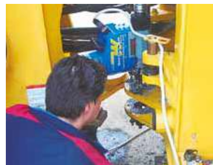
▲ Наплавка и расточка выполняются на мобильном станке
