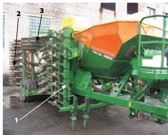
Фото 4. Крепление рабочих органов на боковых рамах сеялки: 1 - почвообрабатывающая часть; 2 - посевная часть; 3 - каток с уплотняющими колесами
