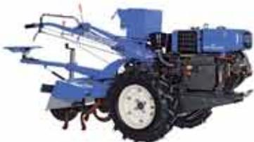
Мотоблоки Скаут мощностью от 8 до 12 лошадиных сил поставляются с почвофрезой и плугом.
