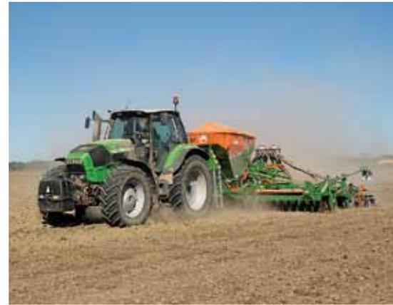
Фото 6. Комбинированная сеялка Cirrus 6002 в агрегате с трактором Agrottron 720 в работе
