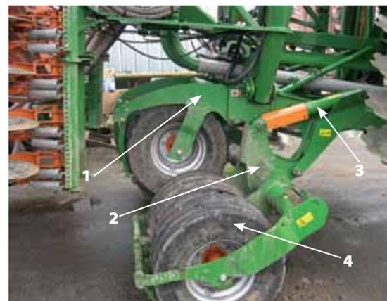
Фото 3. Механизм перевода колес сеялок в транспортное положение: 1 - рама центральная; 2 - кронштейн поворотный; 3 - гидроцилиндр; 4 - колеса уплотняюще-ходовые
