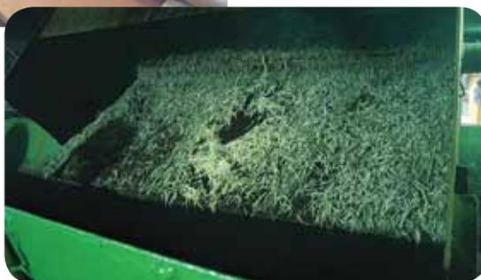
*Измельченная в стружку сахарная свекла дальше будет обработана горячей водой в диффузорах*
