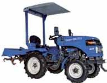
Минитракторы Скаут мощностью от 12 до 24 лошадиных сил поставляются в комплекте с почвофрезой и двухкорпусным плугом.
