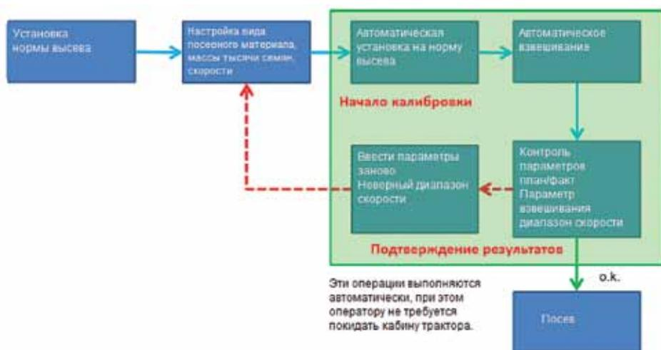
Схема автоматической пробы установки на норму высева
