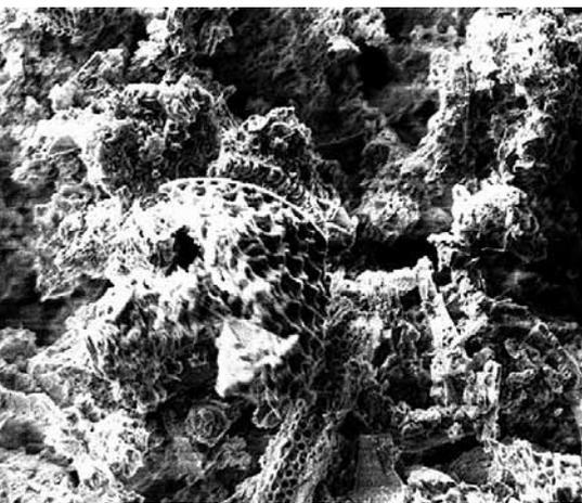
Рис. 3. Фотография микроструктуры сорбента Заслон под электронным микроскопом
