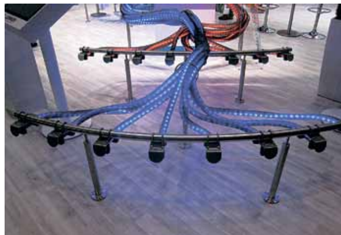
← Навесная пневматическая сеялка VENTO с 12В приводом и пневматическими высевальными трубками
