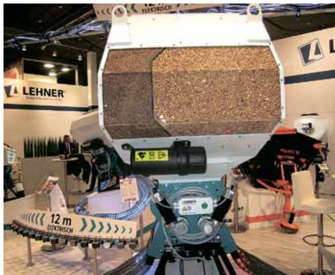
← Навесная пневматическая сеялка VENTO с 12В приводом и пневматическими высевальными трубками
