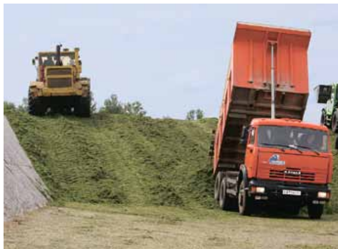
→ Перед трамбовкой травяную массу необходимо правильно распределить по траншее
