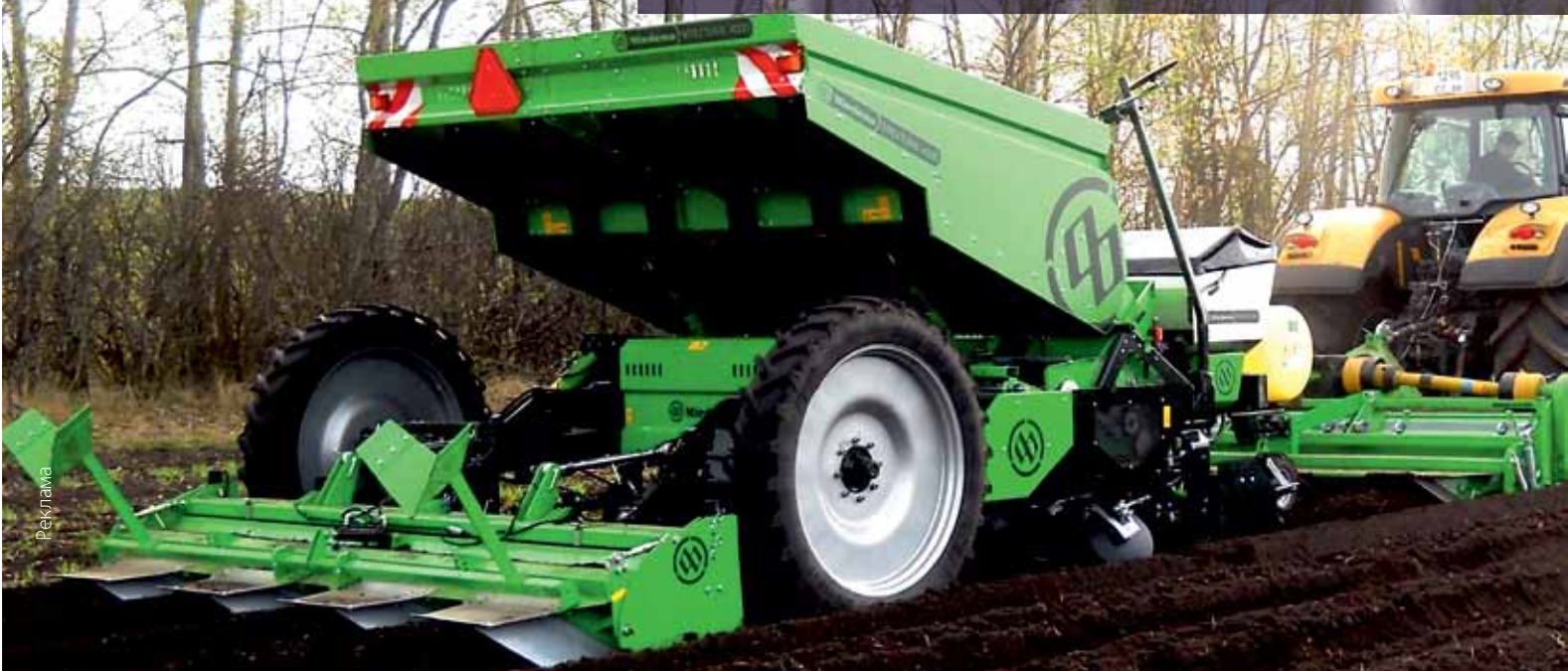
Уникальная комбинация на базе тросовой картофелесажалки Miedema Structural 4000
