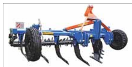
▲ Модульные плуги-рыхлители «Зубр» с рабочей шириной 3-4 м
