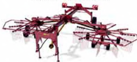
Габри 2-роторные прицепные KOLIBRI DUO 810 ширина захвата 6,9–7,7 м производительность до 8 га/ч
