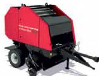
Пресс-подборщик рулонный PELIKAN MAX 1500 ширина захвата 2 м производительность до 12 т/ч
