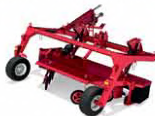
Косилка прицепная BERKUT 3200/3500 ширина захвата 3,2 и 3,5 м производительность до 5 га/ч
