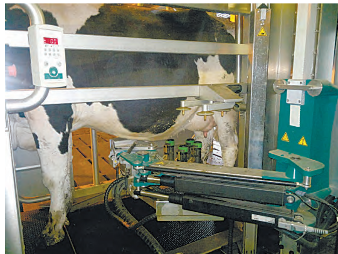
Рука-манипулятор определяет положение вымени и координаты сосков
