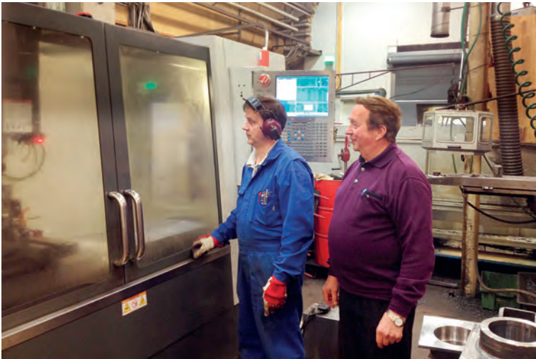
Автоматический фрезерный станок изготавливает части для плющилки
