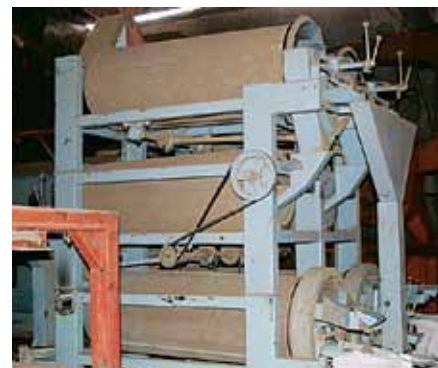
▲ Рис. 3. Триерная очистка семян на машине К553
