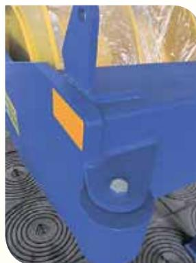
Валики не допускающие контакта корпуса трамбовщика со стенами ямы
