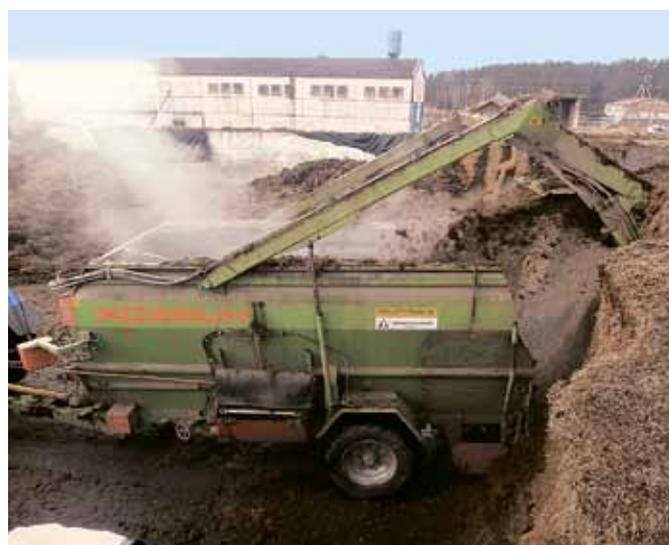
Состоит из бункера, весового механизма, горизонтального двухшнекового рабочего органа, фрезы, механизма раздачи корма с выгрузными лотками, привода рабочих органов, пульта управления рабочими органами, гидросистемы, ходовой системы, оборудованной тормозами, светосигнального оборудования. Снаружи на передней части бункера закреплена лестница для осмотра и регулируемая по высоте опора.
