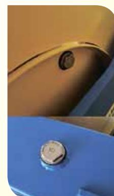
Водозаливные горловины на раме и на барабане катка
