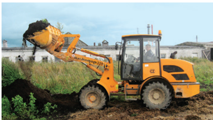
Погрузчик универсальный «Амкодор 320» на погрузке органических удобрений с основным ковшом
