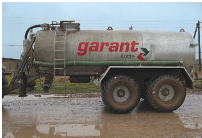
Цистерна VT 14000 для транспортировки и внесения жидких органических удобрений
