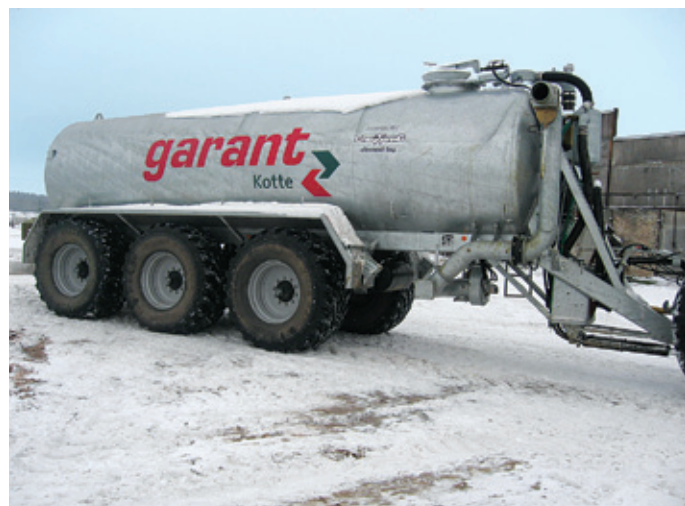
Цистерна VT 25000 для транспортировки и внесения жидких органических удобрений
