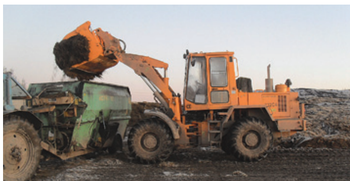
Погрузчик универсальный «Амкодор 332С4» на погрузке силоса с ковшом с прижимом
