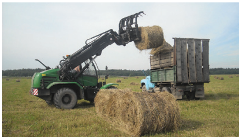
Погрузчик с телескопической стрелой «Амкодор 527» с вилами универсальными на погрузке рулонов сена
