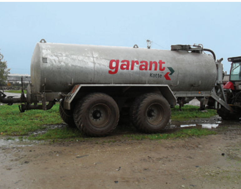
Цистерна VT 16000/5 для транспортировки и внесения жидких органических удобрений
