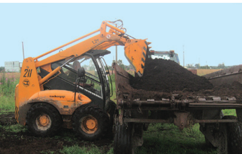
Погрузчик универсальный с бортовым поворотом «Амкодор 211» с основным ковшом на погрузке торфа
