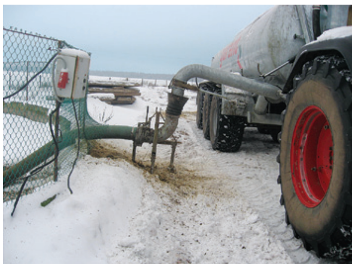
Цистерна VT 25000 в агрегате с трактором FENDT 930 на самозагрузке жидкими органическими удобрениями
