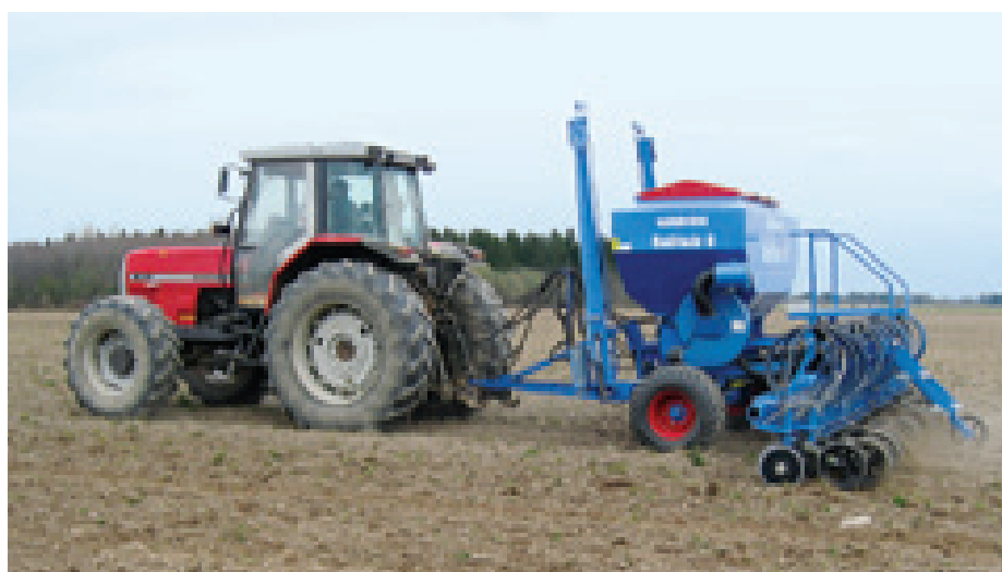
Рис.6. Сеялка пневматическая Solitair 9/600KA в агрегате с трактором Massey Ferguson 8130 в работе.
