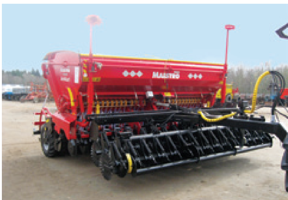
Рис. 1. Сеялка зернотуковая MAESTRO 4000 с двухрядным культиватором с волновыми дисками
