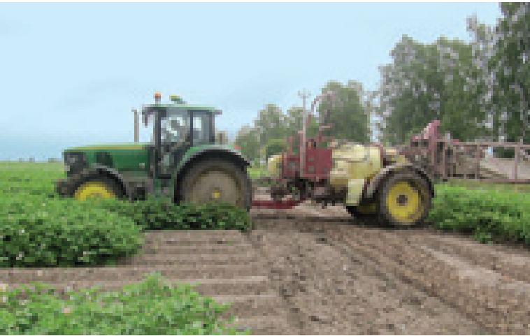
Система AutoTrac в комбинации с GPS приёмником помогает экономно опрыскивать растения
