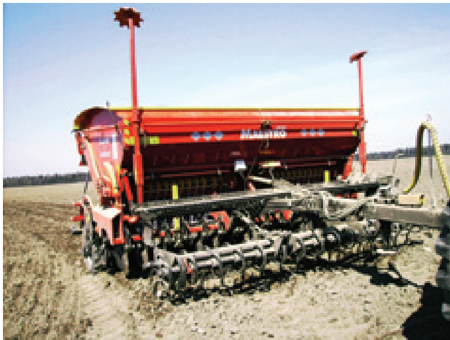
Рис. 2. Сеялка зернотуковая MAESTRO 4000 с двухрядным культиватором с S-образными стойками.
