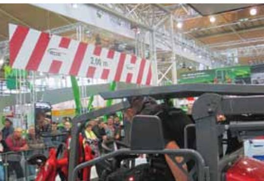
немецкая компания THALER продемонстрировала в действии гидравлически опускаемую крышу Rops-Fops, благодаря чему машина может проезжать под низкими препятствиями без демонтажа защиты. При этом водитель остается защищен и при опущенном положении крыши.
