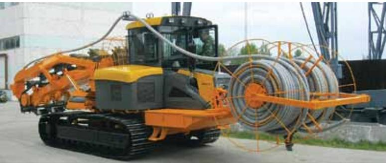
Экскаватор-дреноукладчик с лазерным уклономером ЭТЦ-203 – это траншейный экскаватор, позволяющий прокладывать дренажные траншеи, и после этого укладывать в них дренажные трубы. Он является продолжением знаменитой серии экскаваторов-траншекопателей с применением новейших материалов и технологий. Основной отличительной чертой ЭТЦ-203 от всех его предшественников, является гидравлический привод хода, что делает работу на этой машине плавной и непринуждённой.
