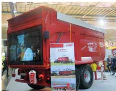
компания Krampe. Борты прицепа изготовлены из одного цельного трехмиллиметрового листа стали марки St52. Дно бункера из одного цельного листа толщиной 4 мм. Задний борт оснащен гидравлическим приводом и автоматическим подпрессовыванием снизу.
