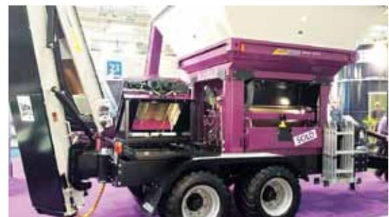
Еще одна новинка фирмы – ленточный транспортёр для шасси W-Max, который может заменить цепной транспортёр. Те модели вальцовых и дисковых мельниц, которые транспортируются на шасси, смогут быстрее выгружать сплющенное зерно. Более высокая производительность нового транспортера позволит мельницам лучше реализовать свой потенциал по производительности. Ленточный транспортер поворачивается на 180 градусов.
