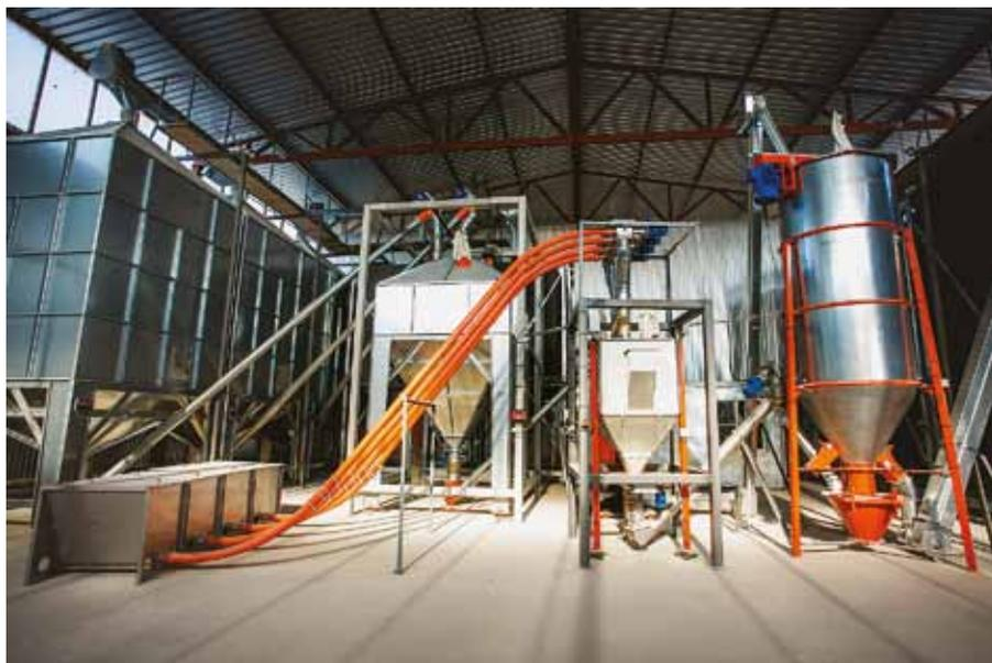
◀ Комбикормовый завод Gruber – это приемка, очистка, хранение, дозирование, дробление и смешивание сырья, выгрузка готового корма
