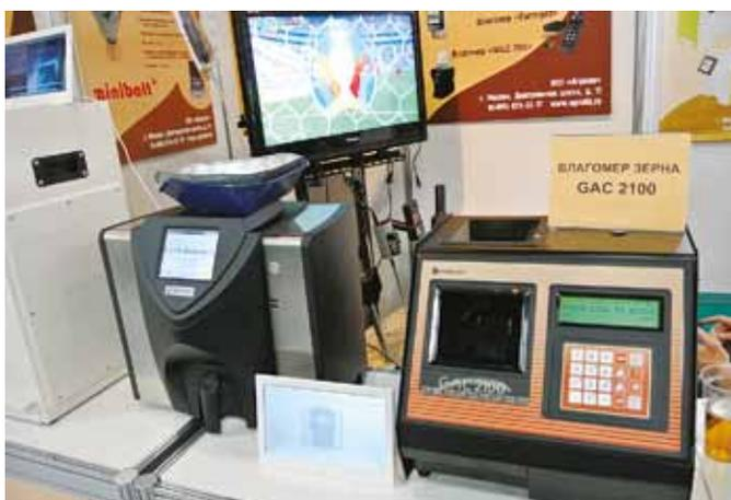
Влагомер зерна быстро и с высокой точностью определяет влажность, натуру и температуру зерна, семян и других сыпучих продуктов. Его можно подключить к компьютеру, а также встроить в производственную линию для проведения измерений в потоке.
