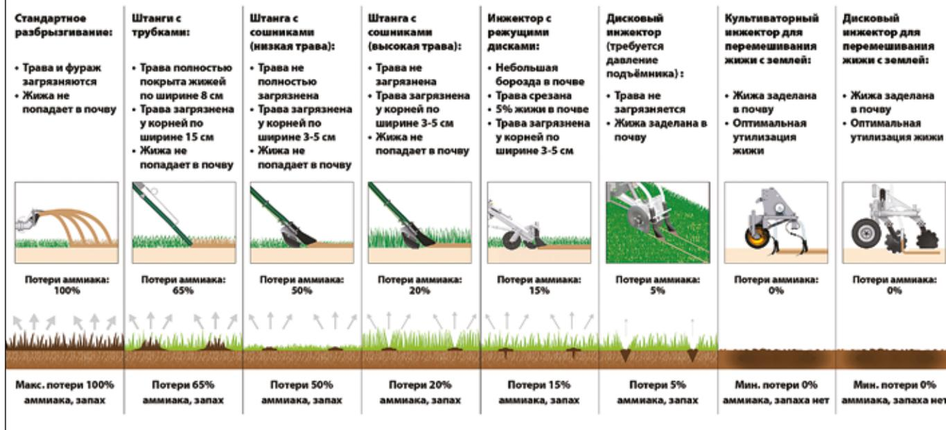
орудия. Для гарантии однородного распределения и предотвращения образования пробок в трубках, штанги оснащены одним или несколькими распределителями. Самозатачивающиеся ножи, изготовленные из стали и установленные на противорез, не только измельчают волокна, но и обеспечивают перемалывание любого постороннего предмета.
