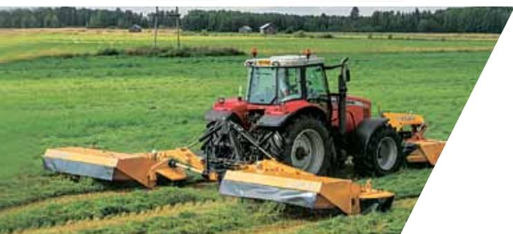
**Модели и варианты комбинаций косилок,** производимых ELHO, удовлетворяют любым требованиям. Мы производим косилки для задней навески, передние, прицепные, бабочки, триплексы. Ширина захвата от 2 м до 10,5 м. Косилки по желанию комплектуются кондиционерами или плющилками. Конструкция косилок, в частности косилочный брус и система копирования и защиты ГидроБаланс, обеспечивают надежность и необходимое качество косыбы.
