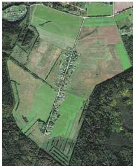
Рисунок 2. Фрагмент аэрофотоснимка мелиоративной системы
