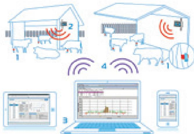
обеспечение управления стадом AfiFarm. Программное обеспечение управления стадом анализирует данные датчиков для заполнения отчетов (коровы на осеменение, анэструс и абортос). Доступ к данным по Web-каналам возможен круглосуточно и без выходных.
