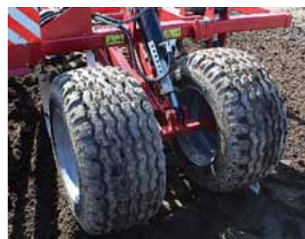
◀ Культиватор серии КГП ▶ Гидравлическая регулировка глубины обработки
