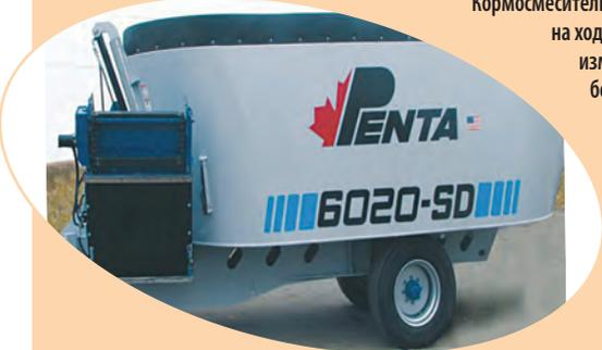
Рама повышенной прочности. Повышенная прочность оси и дисков колес. Электронная весоизмерительная система на трех точках опоры. Идеальная очистка рабочей камеры посредством новейшего винтового шнека измельчителя. Оригинальная комбинация высокопрочных ножей повышает эффективность измельчения и смешивания, снижает нагрузку на тракторный привод и потребление горючего.
