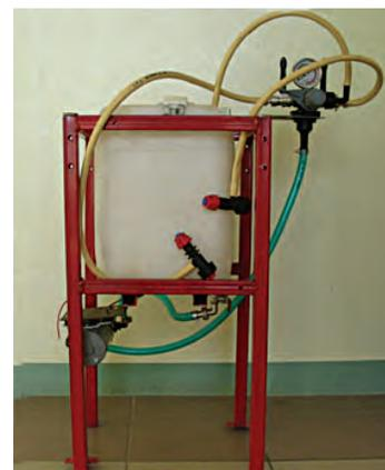
Рис. 2. Приспособления конструкции ГНУ ВИЗР на картофелесажалку для протравливания клубней картофеля непосредственно при посадке
