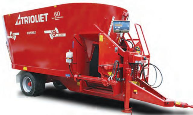
Новинка 2011 года – 12-ти кубовый смеситель-кормораздатчик Trioliet Solomix 2 12VLC с изменяемыми высотой выгрузки и длиной транспортера.
