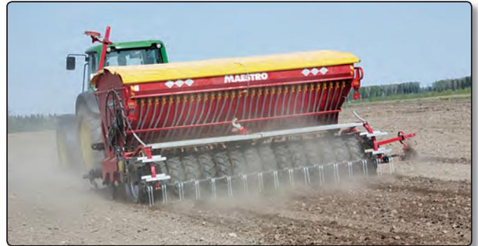
Универсальная зернотуковая сеялка Маэстро одинаково подходит как для минимальной предпосевной обработки почвы, так и для традиционных методов и прямого сева.
