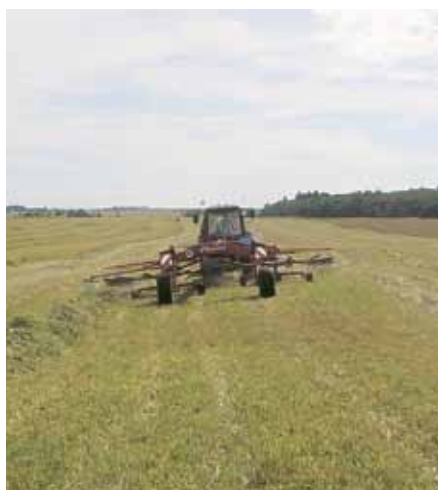
↗ Валкообразователь Тааруп 9577 S в агрегате с трактором Беларусь 82.1 в работе
