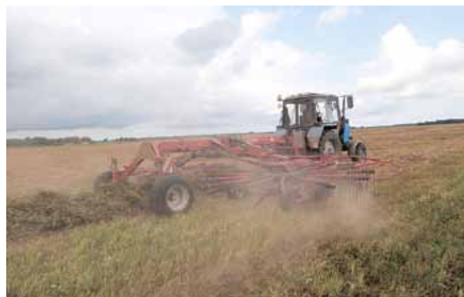
◀ Валкообразователь TAARUP 95110 C в агрегате с трактором CASE 165 в работе
