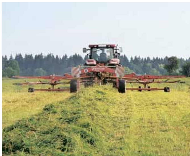
◀ Валкообразователь TAARUP 95110 C в агрегате с трактором CASE 165 в работе
