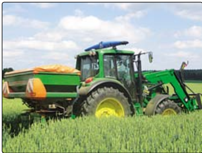
Сенсорное устройство, установленное на тракторе по цвету листа определяет содержание питательных веществ в растении. Эта информация передается на разбрасыватель удобрений, и он вносит строго необходимое его количество.
