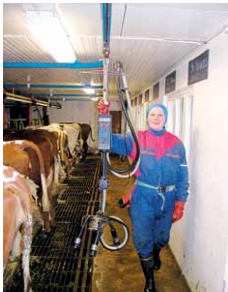
Доение в стойлах значительно облегчается с помощью доильной рельсы. Фото: Markku Lähti
