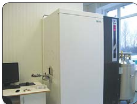
Автоматизированное хранилище микроорганизмов при сверхнизкой температуре
