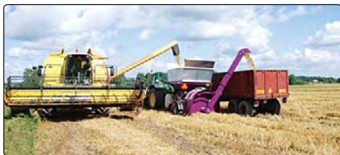
Вальцовая мельница Murska может быть одновременно оборудована элеватором и упаковочным выходом
