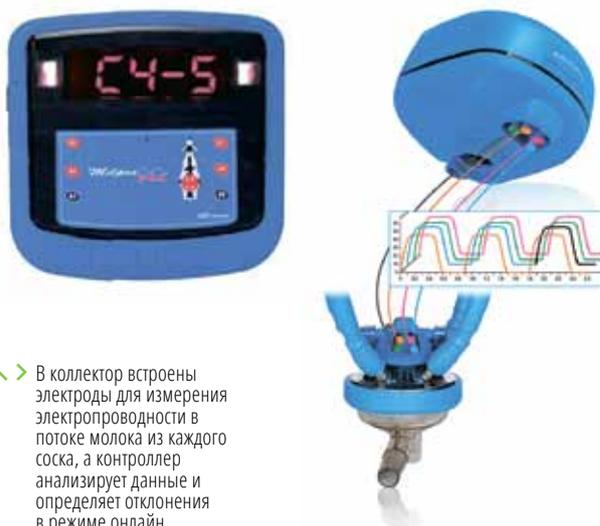
↗ В коллектор встроены электроды для измерения электропроводности в потоке молока из каждого соска, а контроллер анализирует данные и определяет отклонения в режиме онлайн
