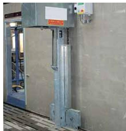
➤ Зарядная станция для робота-навозоудалителя
