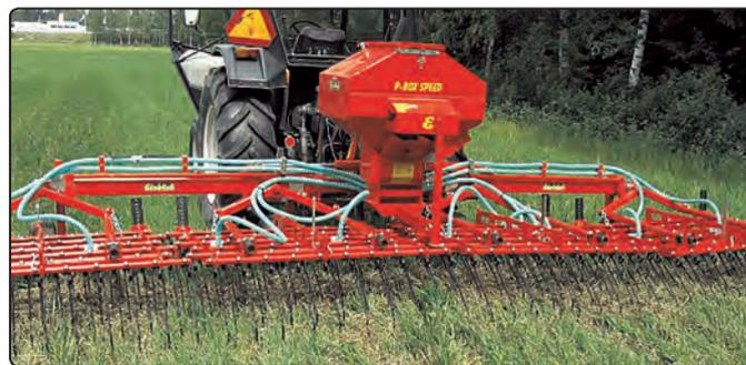
Фото 1. Посев разбрасыванием – лучший способ достижения плотного посева трав. К травяной бороне добавлена пневматическая разбрасывающая сеялка.
